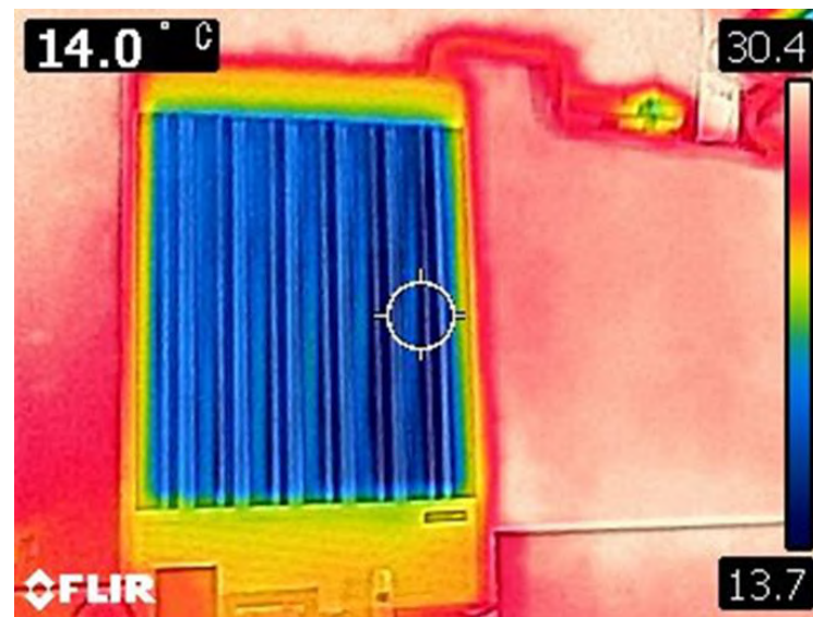
冷房運転定常時のパネル赤外線画像
